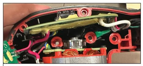
MAKE SURE THE MAIN BOARD IS IN HOUSING HALVE SLOT GROOVES.
