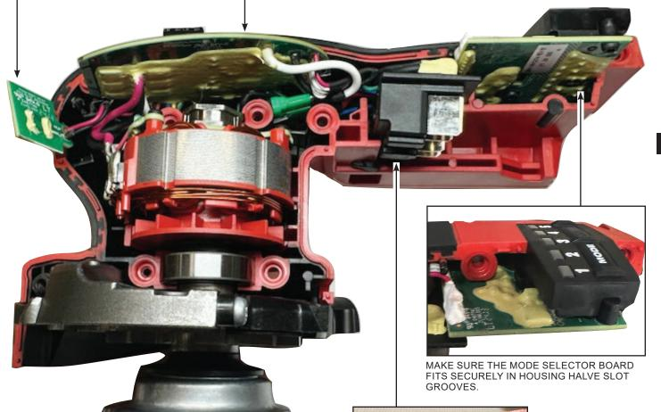
MAKE SURE THE TERMINAL BLOCK FITS IN HOUSING HALVE SLOT GROOVES.
