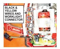
INSTALL THE WIRES INTO THE HOUSING TRAPS.
