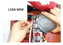
BE SURE TO PULL THE LENS WIRE WHILE INSTALLING THE REAR GEARCASE.
