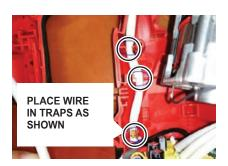
INSTALL THE B+ AND SIGNAL WIRE TO THE HANDLE GROOVE AS SHOWN.
