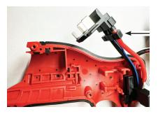
INSTALL THE RUBBER BLOCK TO THE TERMINAL AS SHOWN.
