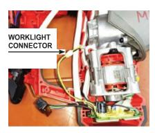
CONNECT THE WORKLIGHT CONNECTOR WIRES.
