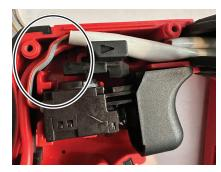
ROUTE TRIGGER WIRES AROUND SCREW COLUMN AS SHOWN.
