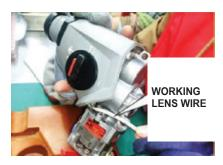
WIRE ROUTING FOR THE WORKING LENS WIRE AROUND THE REAR GEARCASE EDGE.
